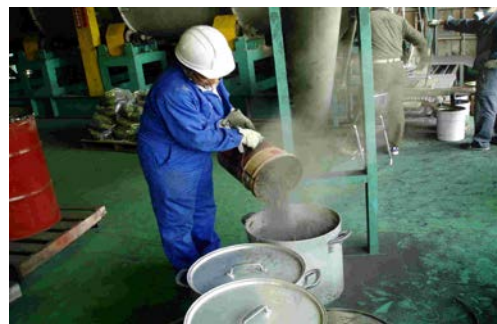
焼却灰を急冷する作業(ケントム社)
